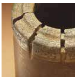
USURE EXTÉRIEURE DE LA COURONNE :
