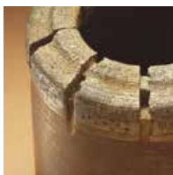
USURE EXTÉRIEURE DE LA COURONNE :
